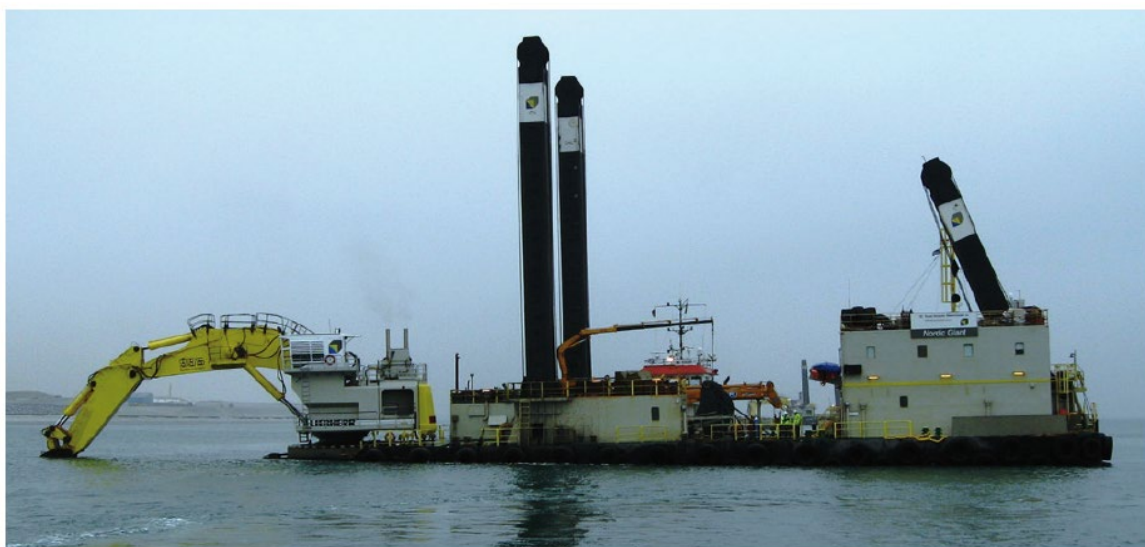
Figur 4-3 Typisk grävmaskin/mudderverk för dikning på grunt vatten.
